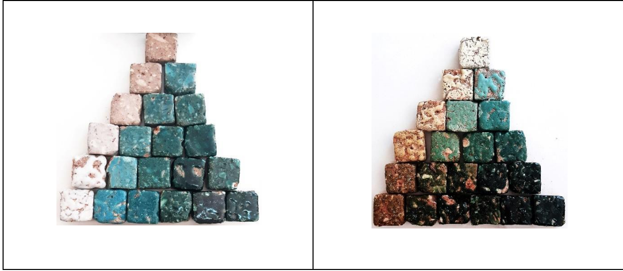
Görsel 6. Üçgen Faz Diyagram Sır Araştırmaları, 1040°C. Fotoğraf: Betül Aytepe Serinsu.
