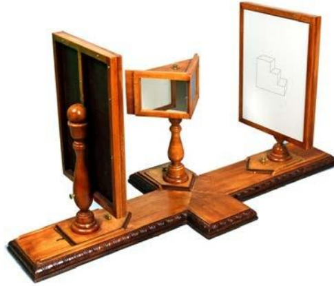
Görsel 2. Charles Wheatstone’un geliştirdiği stereoskop.
